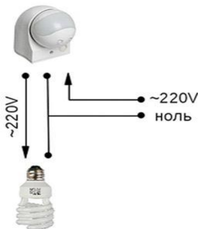
Рисунок схема подключения датчика движения
